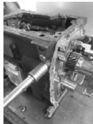
پیچهای و ساچمه ها ینگه دارنده اهرم ها را باز کرده و در بیاورید
