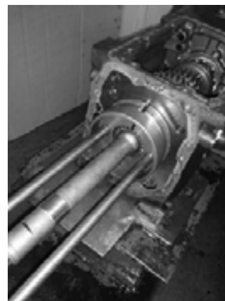
با استفاده از فیسچکر دنده ۵ را در بیاورید
