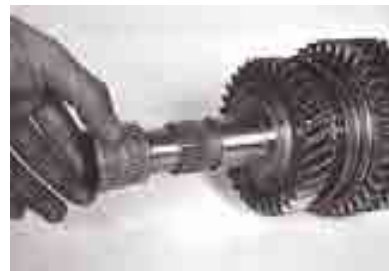
۲- مجموعه توپی کشویی و دنده ۳ را با دنده برنجی توسط پولی ش بیرون بیاورید.
