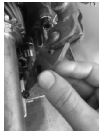
انگشتی میل ماهک دنده ۵ در آورید
