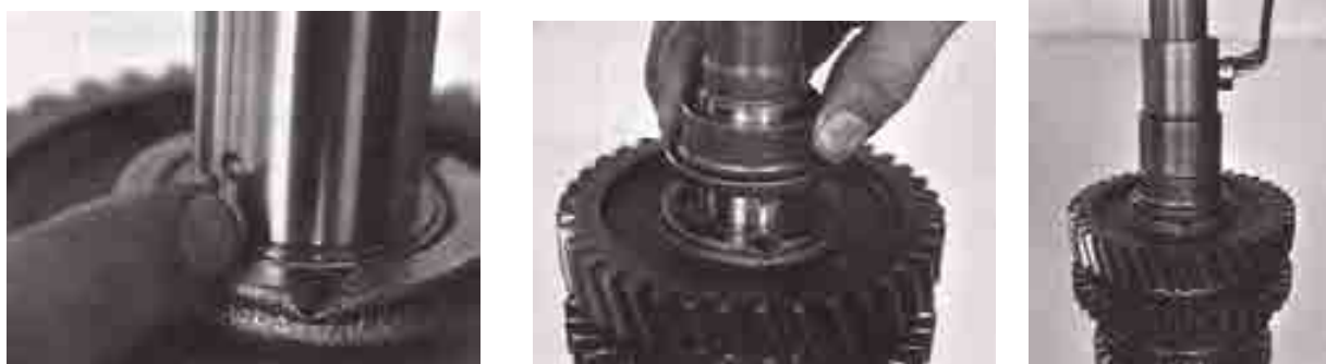
۸- ساچمه گرد نگهدارنده فاصله گذار را با دست و گریس جا انداخته و سپس فاصله گذار را بیاندازید
