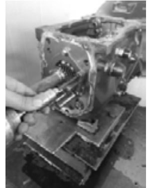
پیچ های اهرم نگهدارنده دنده ۵ را باز کنید اهرم را در بیاورید
