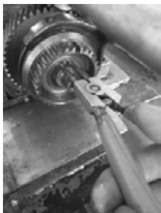
خار دو چشمی توپی دنده ۵ در با خار باز کن در بیاورید
