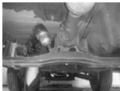
باز کردن پیچهای قفل گاردان
