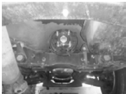
جدا کردن مجموعه گاردان از روی خودرو
