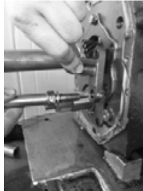
پیچ های اهرم نگهدارنده دنده ۵ را باز کنید اهرم را در بیاورید
