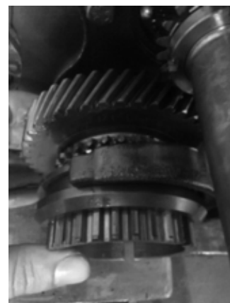
مجموعه دنده درگیره ۵ را با دست در بیاورید
