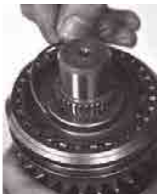
۲- مجموعه توپی کشویی و دنده ۳ را با دنده برنجی توسط پولی ش بیرون بیاورید.
