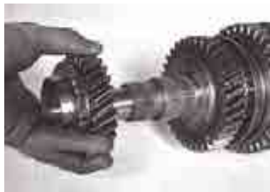
۲- مجموعه توپی کشویی و دنده ۳ را با دنده برنجی توسط پولی ش بیرون بیاورید.
