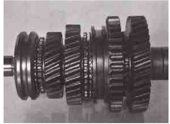
۱۴- جهت اطمینان بیشتر مجموعه شفت اصلی را روی میز گذاشته و دقیقاً تمام قطعات مونتاژ شده را کنترل نمایید.
