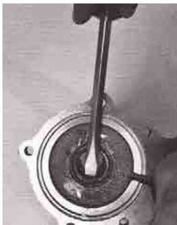
کاسه نمد آداپتور جلویی بوسیله پیچ گوشتی در بیاورید
