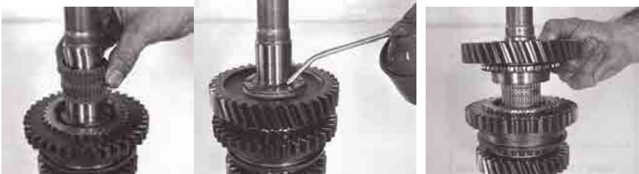
۷- نیدل برینگ را با دنده ۱ مونتاژ کنید. یاد آوری: نیدل برینگها و دنده ها را موقع مونتاژ روغن کاری نمایید.
