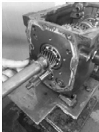
با استفاده از فیسچکر دنده ۵ را در بیاورید
