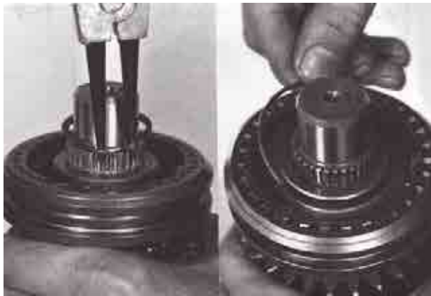
۱۳- النگوی طرف دنده ۴ را با دست جا انداخته و خار نگهدارنده توپی را با خارکش در شیار خود ببندازید و سپس نشستن خار را کنترل نمایید
