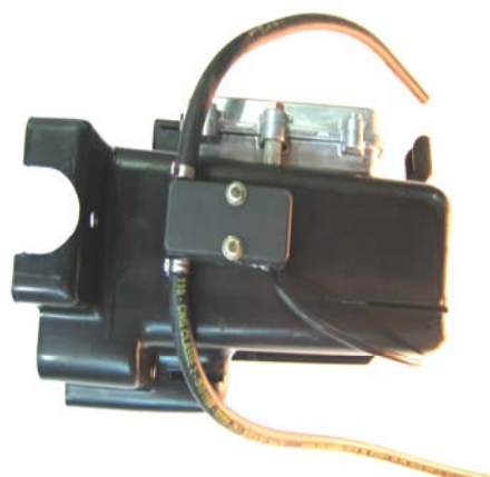
نصب سنسور فشار-خلاء روی جعبه ECU
