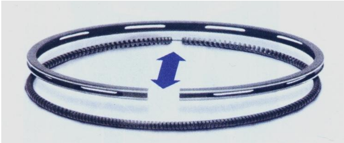
شکل ۱۵- موقعیت دهانه رینگ و دهانه فنر نسبت به هم در رینگ روغن فنردار
