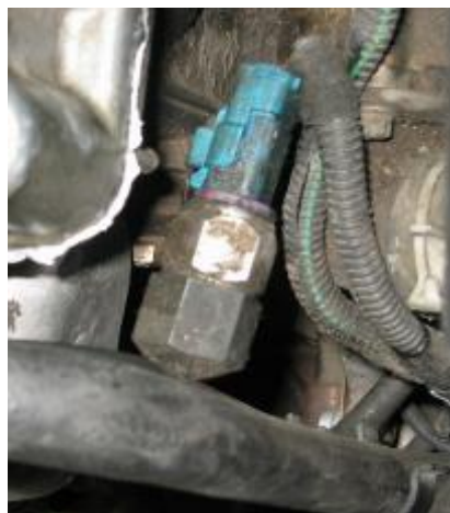
فشنگی روغن هیدرولیک موجود بر روی مدار هیدرولیک فرمان
